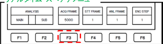
(3) ① “F3” 取り込むフレーム数(時間)を設定。 ② “HOLD/RUN” 測定。
