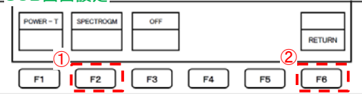
(2) ① “F2” SUB画面のスペクトログラムを選択。 ② “F6” リアルタイム・スペアナメニューに戻る。
