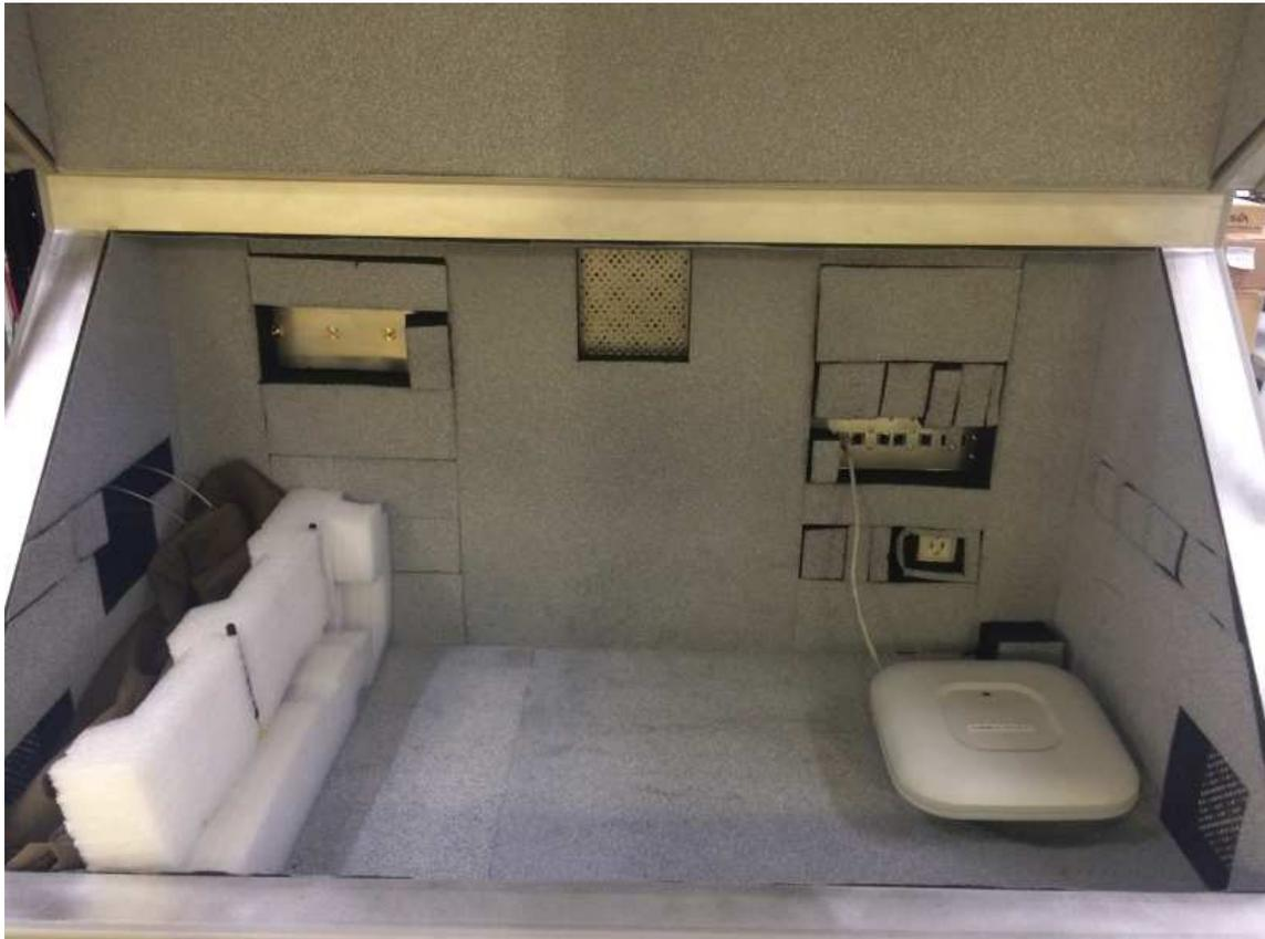
写真 2●電波暗箱を使った実験環境の様子
