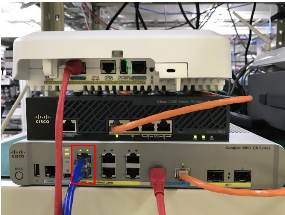
上の写真の青色ケーブルをスイッチにつないだ（左下にある青色ケーブル 1Gbps×2 ポート）
