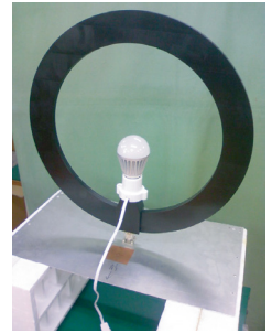
LED照明の放射雑音測定
