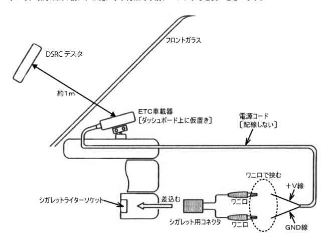
取り付けようとするETC車載器をダッシュボードの上に置き、ETC車載器から出ている電源コードの+V線とGND線を各々ワニロクリップで挟んで、シガレット用コネクタをシガレットライターソケットに差込みます。なお、ETC車載器によりACC線が追加されているものもあります。この時はACC線と+V線を絡げてワニロクリップで挟みます。
