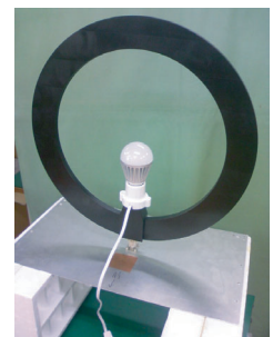
LED照明の放射雑音測定
