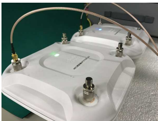
写真 1●外部アンテナモデルのアンテナ端子を RF ケーブルに接続している様子
