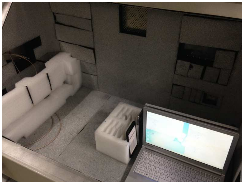
写真 3●電波暗箱内の様子
